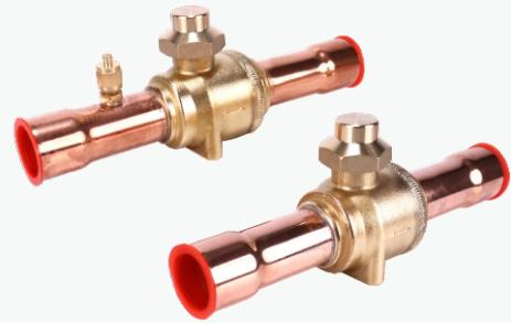
球阀是手动调节的截止阀,适用于双向流动,用于冷冻、冷藏和空气调节装置的液体、吸气和热气管路上,阀座与密封处具有很好的密封性,球阀为直通型,可提供最大的流量,同时该阀的工作温度范围宽,球阀配有一个带二次密封的密封帽。
