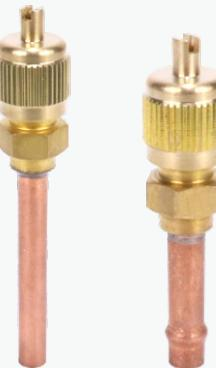
LFCV 充注阀是一种带气门芯的单向检修用阀，充注阀用于冷冻、冷藏和空调调节装置的各个部位。采用优质供应商气门芯，性能可靠。双重密封确保无泄漏，可提供各种长度和硬度的铜接管，阀帽滚花设计，装卸方便。
